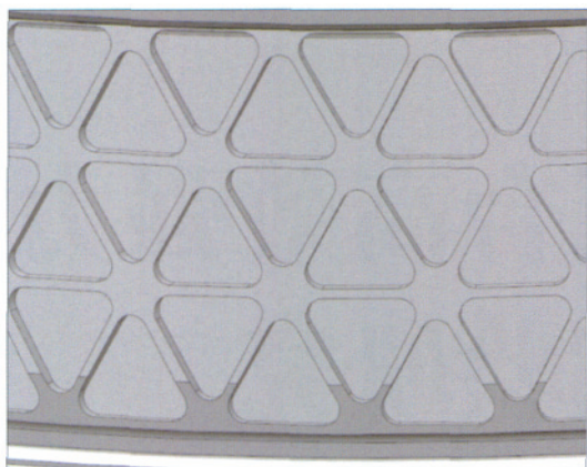
图4 化学铣结构零件特征
